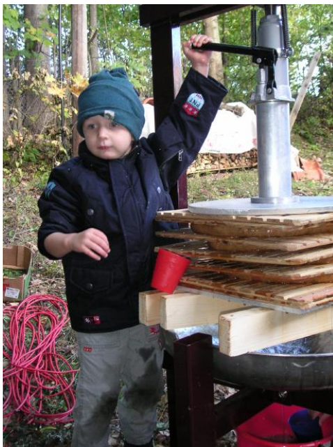
Figur 3: Pakkepresse under pressing. Stabelen presses sammen med pressen og mosten renner ned i saftbakken og videre til beholderen.
