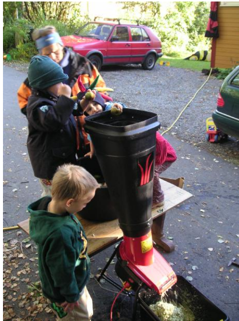
Figur 1: En elektrisk eplekvern til findeling av epler leverer passende små eplestykker.
