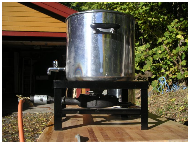
Figur 4: 9kw gassbrenner til å varme opp 20l most om gangen
