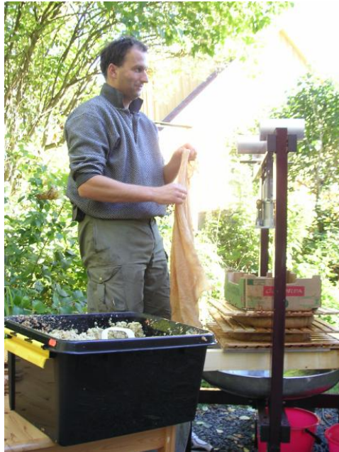
Figur 2: Pakkepressen under oppbygging av pakkene. Et presseklæde legges over pakkerammen i saftbakken og eplepulp fordeles og pakkes in i striduken. Pakkerammen fjernes og en pressrist legges over. Denne prosessen gjentas til hele stabelen er bygget opp.
